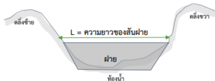
ภาพที่ 2.5 ระยะในการคำนวณอัตราการไหลของฝายฯ
